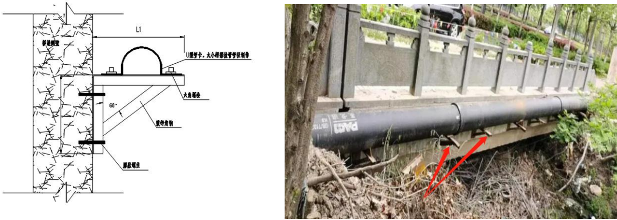
图 4-38 管道随桥架管做法示意图
